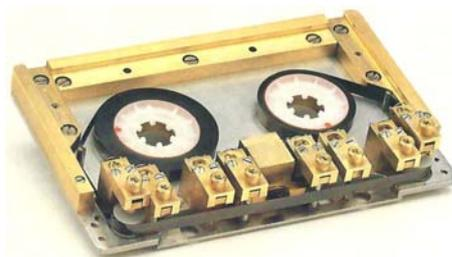
*Рис. 5 – Эталонная компакт-кассета BASF, использовавшаяся для контроля пресс-форм на промышленном производстве*
