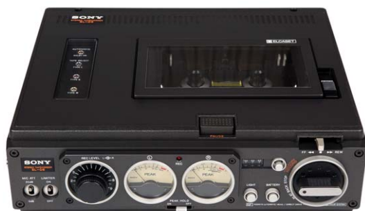
Рис. П4-1 – Sony EL-D8 (1977). Единственная портативная дека Elcaset.
