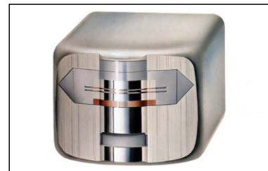
Рис. 16 – Магнитная головка Crystalloy (Nakamichi).
