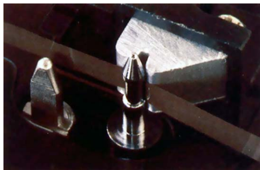
Рис. 17 – Штифт натяжения с направляющей ленты (Hitachi D-3500).
