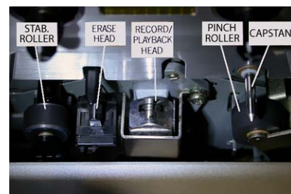
Рис. 22 – Стабилизирующий ролик (Sony TC-K80).
